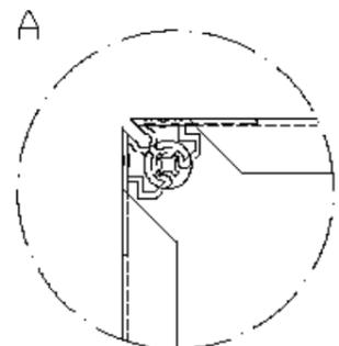
A: Kanallı dik köşe / Vertical channel corner / Вертикальный канальный угол
